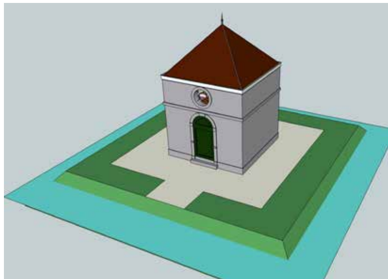
Reconstructie van het eerste kruithuis op basis van de maatvoering uit het bestek. (reconstructie auteur)
